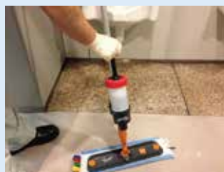
ボトル上部のポンプをプッシュしてボトル内部に空気を入れてください。
